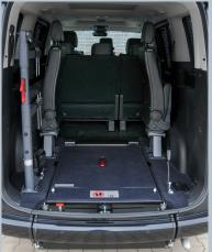
Die eingeklappte **EASY**FLEX Rampe ermöglicht die volle Nutzung des Kofferraums.
