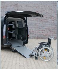
Bei ausgeklappter Rampe lässt sich das Fahrzeug bequem mit dem Rollstuhl befahren.
