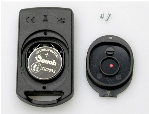
Abbildung 19: Batterie einsetzen
