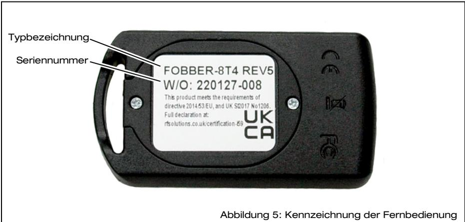
Abbildung 5: Kennzeichnung der Fernbedienung
