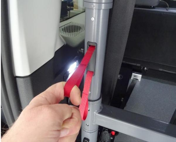
Abbildung 7: Bedienschleife ziehen (hier: Schwenkarm der Kopfstütze)
