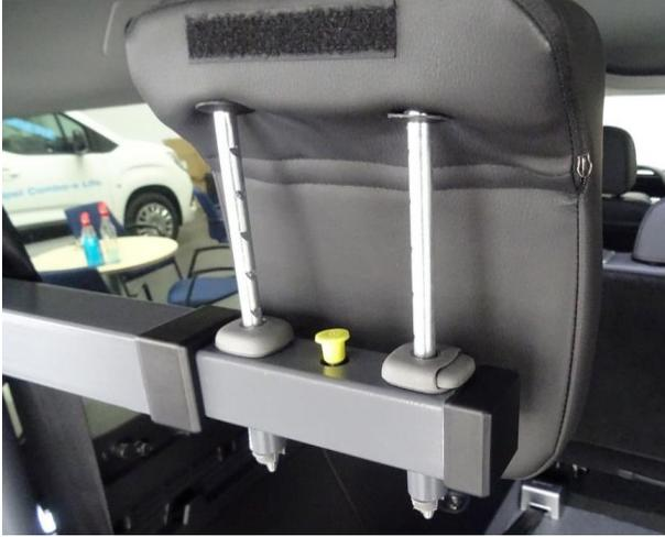
Abbildung 10: Kopfstütze in höchster Position
