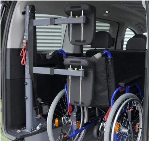
Abbildung 6: Schwenkarme quer zur Fahrtrichtung
