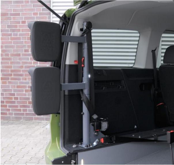
Abbildung 5: Schwenkarme nach hinten gedreht
