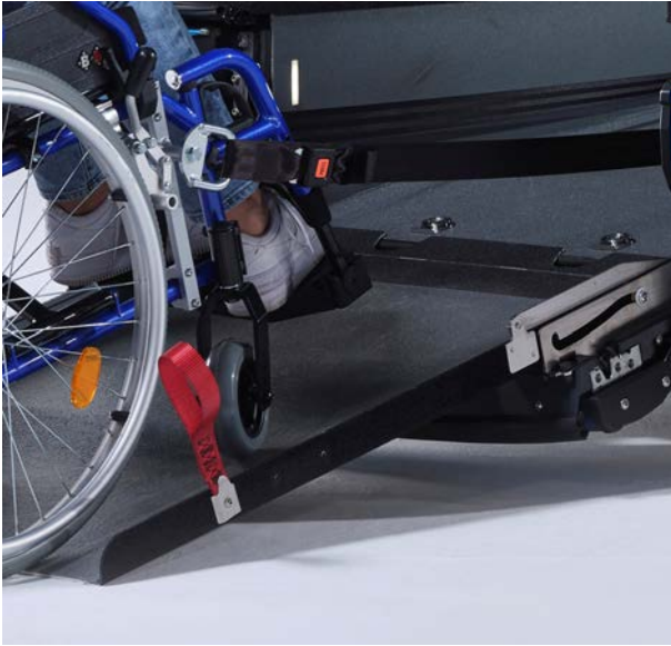
Abbildung 16: Elektrogurte am Rollstuhl angeschlossen
