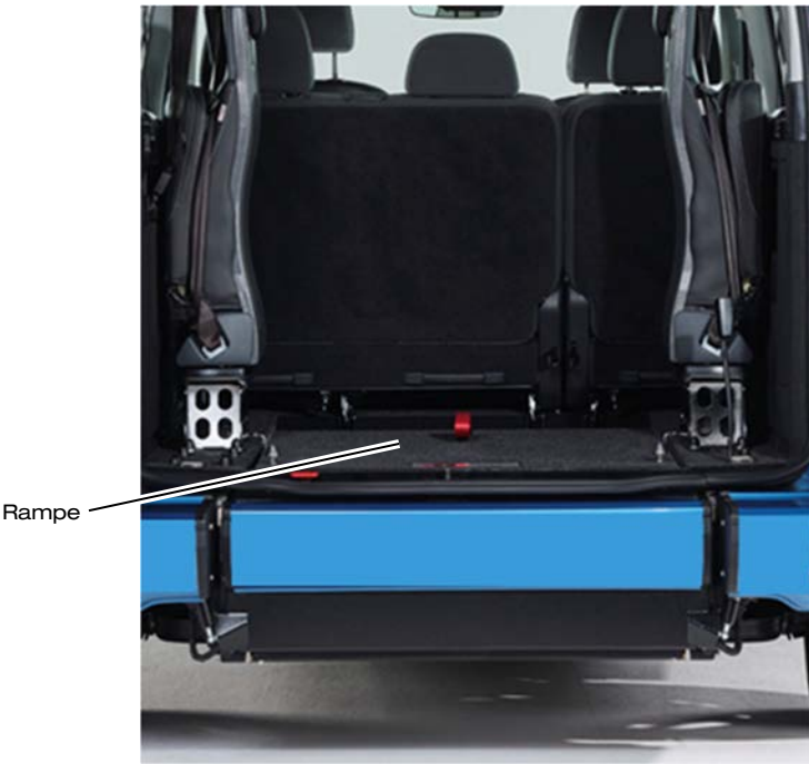
Abbildung 3: Vollständig nach innen eingeklappte EasyFlex Rampe
