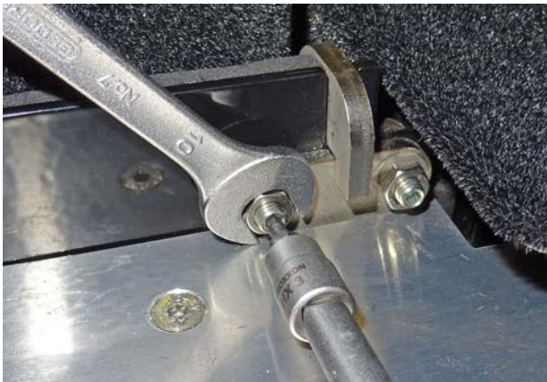
Abbildung 26: Spiel über die Einstellschrauben einstellen
