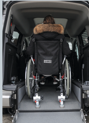
Hintere Befestigung des Rollstuhls durch Retraktoren
