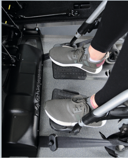
Vollintegriertes Rückhaltesystem geprüft nach ISO 10542 und DIN 75078-2
