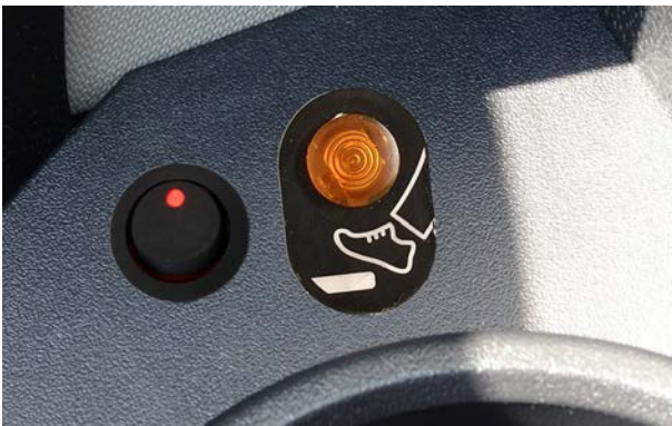
Abbildung 11: Deaktivierungsschalter neben Signallampe
