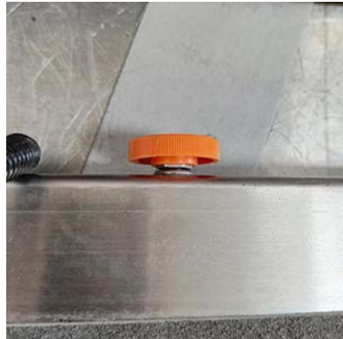
Abbildung 13: Rändelschraube zur Not-Entriegelung
