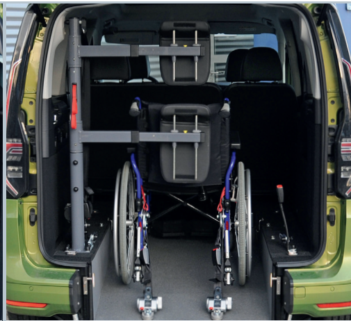
Mit dem integrierten Schultersträggurt und dem PROTEKTOR Personen- & Rollstuhlrückhaltesystem ist der Rollstuhlfahrer optimal gesichert.
