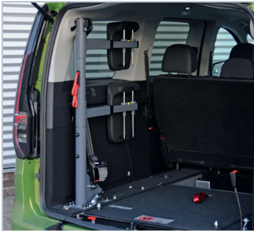
Der FUTURESAFE lässt sich platzsparend zur Seite schwenken, wenn kein Rollstuhl transportiert wird.
