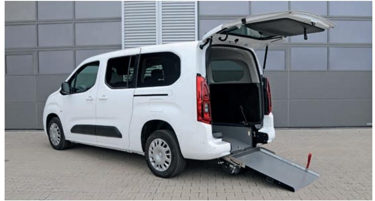
genutzt werden. Außerdem lässt sich die Auffahrrampe mit der EasyUse Funktion leicht und mühelos mit nur einer Hand bedienen.
