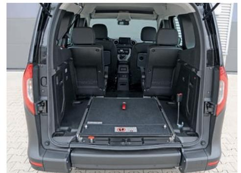
stütze einfach zur Wand schwenken. Mit dem Einbau von zwei Einzelsitzen in der 2. Reihe bieten alle Fahrzeuge Platz für bis zu vier Personen, sowohl mit als auch ohne Rollstuhlsassen. **Hinweis:** Aufgrund der werkseitigen Richtlinien sind die genannten Fahrzeuge nur als Benziner umbaubar.
