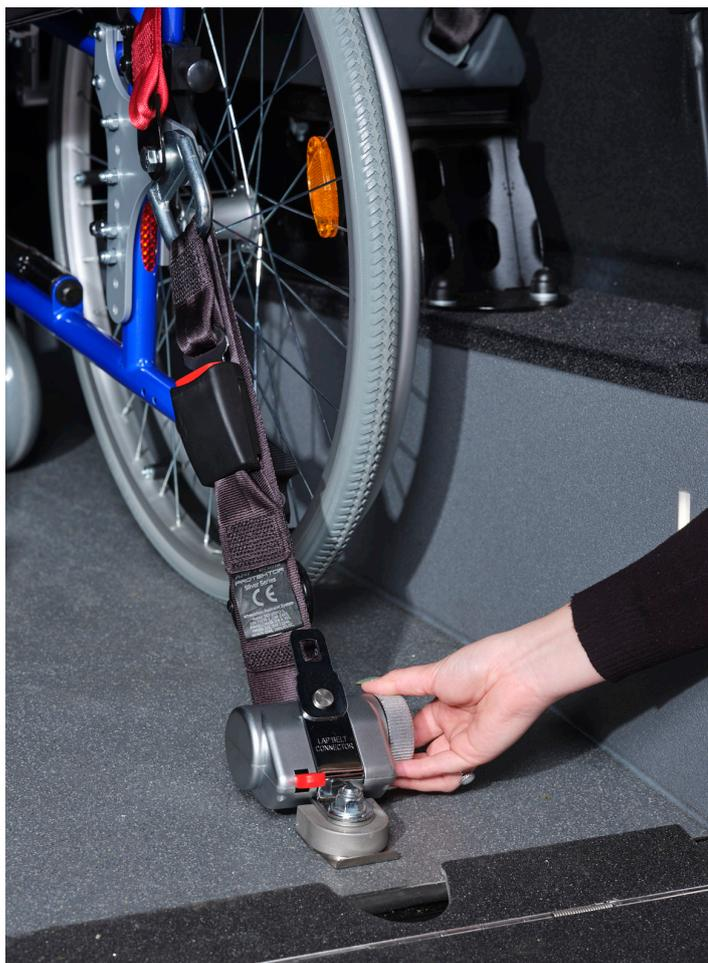
AMF-Bruns entwickelte als weltweit erster Hersteller ein Retraktor-4-Punkt-Sicherungssystem für Personen und Rollstühle. Mittlerweile ist das AMF-Bruns PROTEKTOR System zu einem weltweiten Standard geworden. Es ist einfach, schnell und sicher in der Anwendung.
