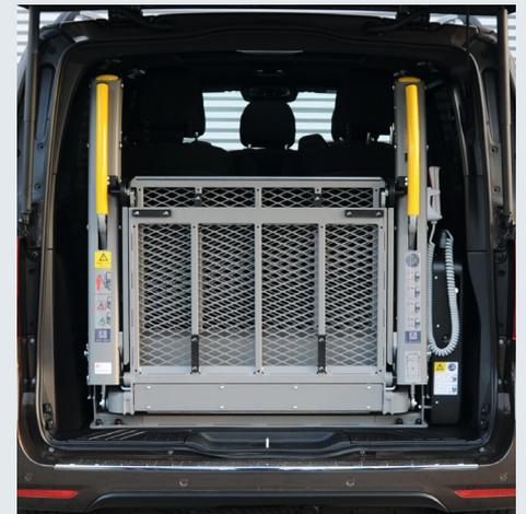
Die Panorama-Plattform ermöglicht den Einbau eines großen Liftes in Fahrzeugen mit geringer Innenhöhe.
