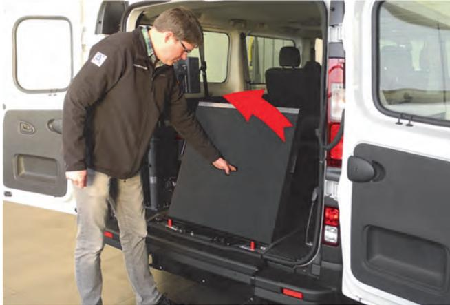
2. Drücken Sie den Bedienehebel für das Ausklappen nach links.
