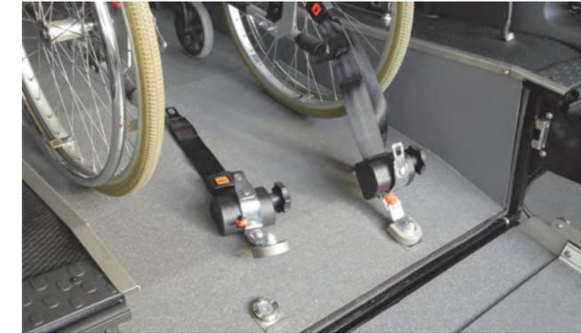
3. Spannen Sie die Retraktoren durch Anziehen der Gurtrollen.
