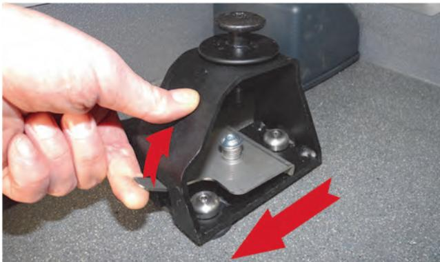
1. Heben Sie das Sicherungsblech eines Sitzhalters an.
