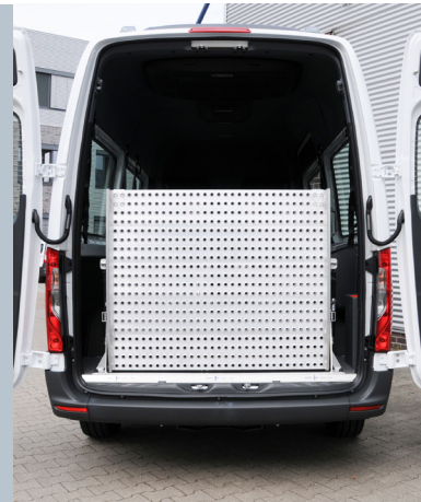
Fahrzeug mit eingeklappter Rampe. Durchsicht nach hinten bleibt erhalten.
