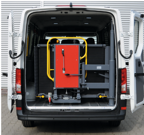
Schwenklift kann platzsparend eingeklappt werden.
