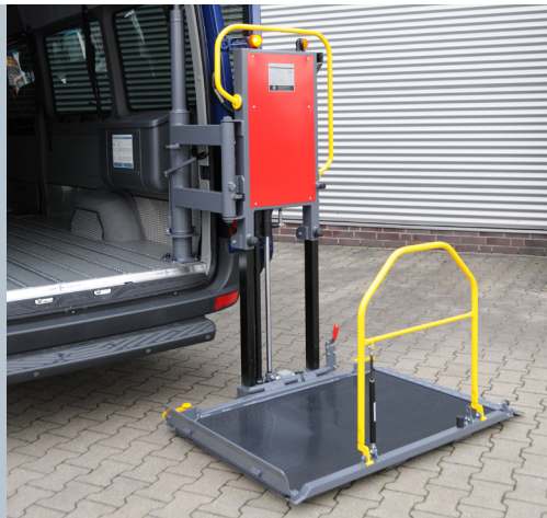
Abgesenkter Lift, zur Aufnahme des Fahrgastes bereit.
