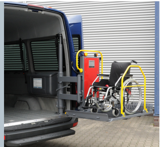
Der AMF-Bruns Schwenklift BSL 350 beim Heben.
