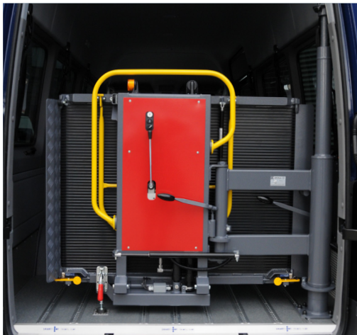
Schwenklift platzsparend ins Fahrzeug eingeklappt.
