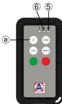
6. Drücken Sie die Taste **(b)** solange, bis die LED **(5)** und die LED **(6)** gleichzeitig blinken.
