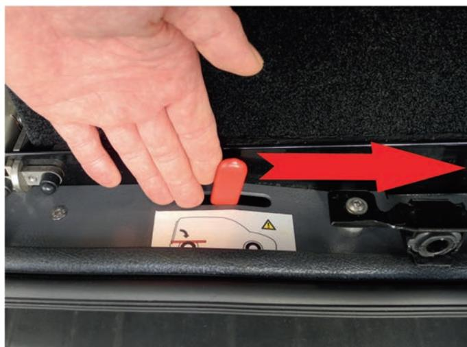
Abbildung 19: Rampe entriegeln
