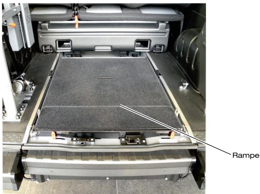
Abbildung 18: Vollständig nach innen eingeklappte Rampe (nur Easy-Flex)
