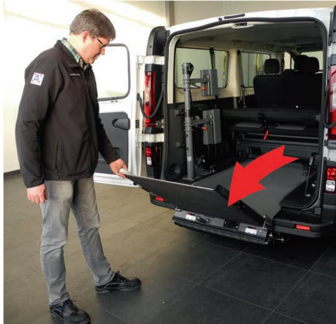
Abbildung 11: Rampe ausklappen
