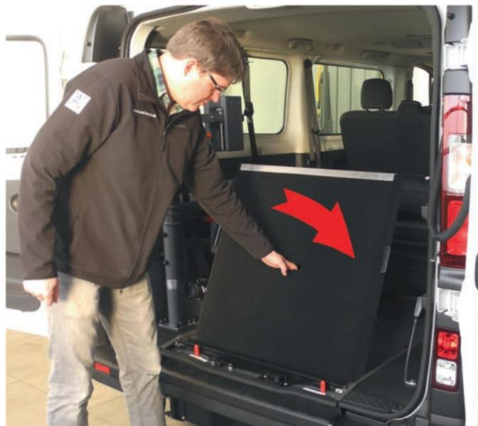
Abbildung 20: Rampe einklappen
