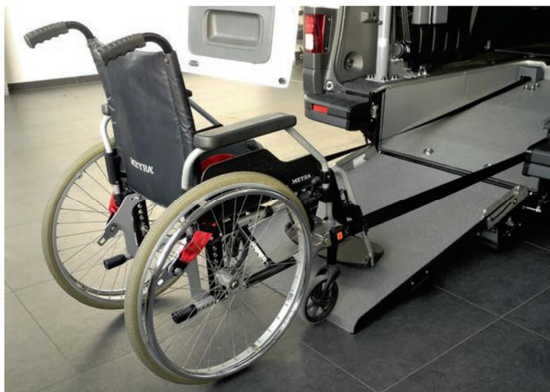
Abbildung 15: Elektrogurte am Rollstuhl anschließen
