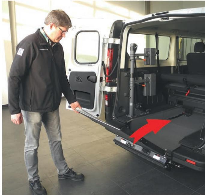
Abbildung 17: Rampe hochklappen
