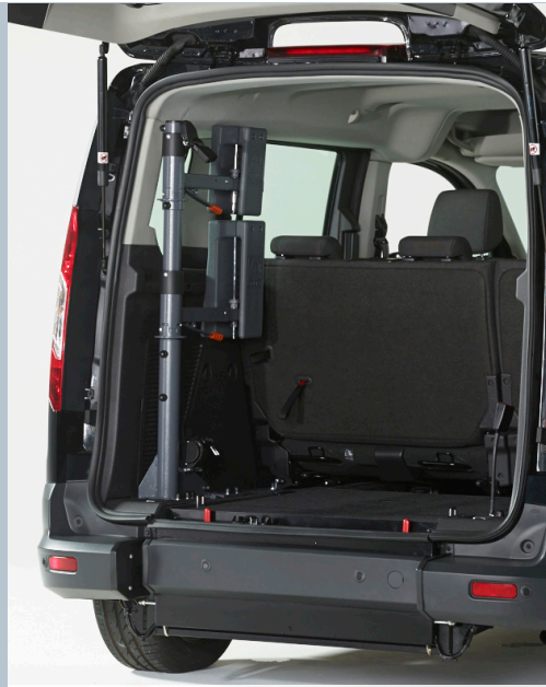
FUTURESAFE® mit Bodenbefestigung, platzsparend zur Seite geschwenkt.
